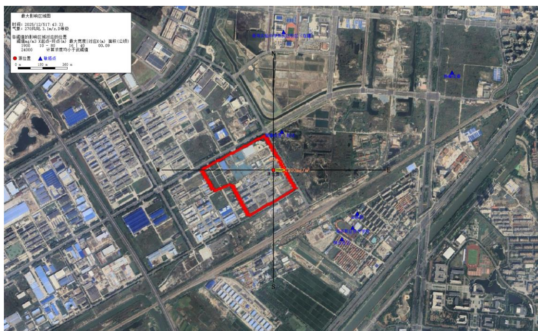
图 6.8-5 二氯甲烷储罐泄露最不利气象条件下二氯甲烷毒性浓度影响范围图
