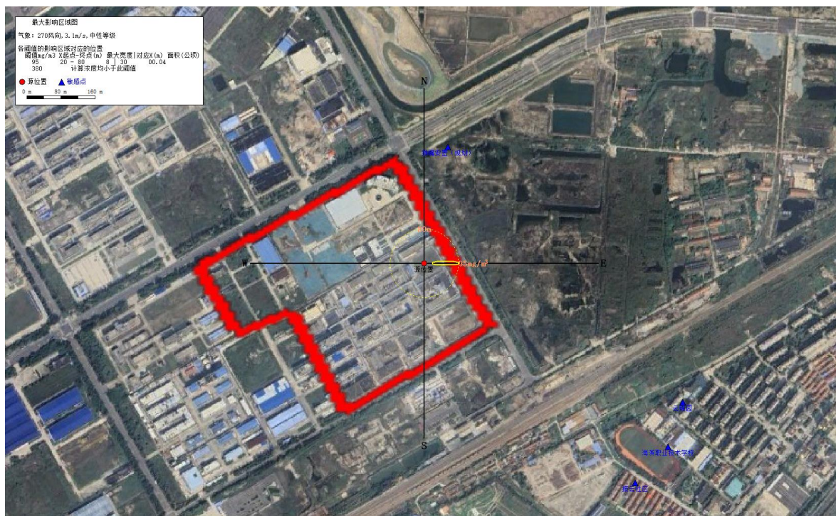
图 6.8-4 甲醇储罐泄漏火灾爆炸次生/伴生 CO 最常见气象条件下毒性浓度影响范围图
