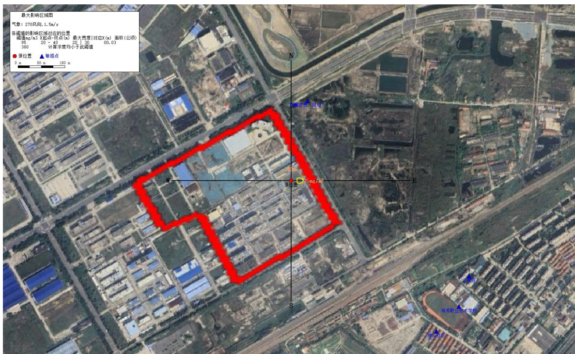
图 6.8-3 甲醇储罐泄漏火灾爆炸次生/伴生 CO 最不利气象条件下毒性浓度影响范围图
